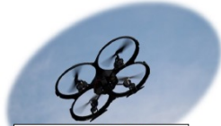
Die meisten Drohnen, denen wir im Alltag begegnen, haben vier Rotoren und heissen Quadrokopter .
