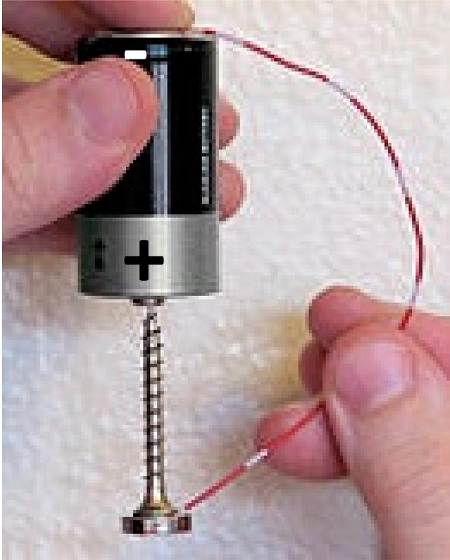
Ein Magnet unter dem Schraubenkopf erzeugt ein Magnetfeld.
